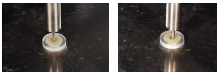
ภาพประกอบที่ 3 ชิ้นทดสอบที่ถูกทดสอบด้วยเครื่องทดสอบสากล
